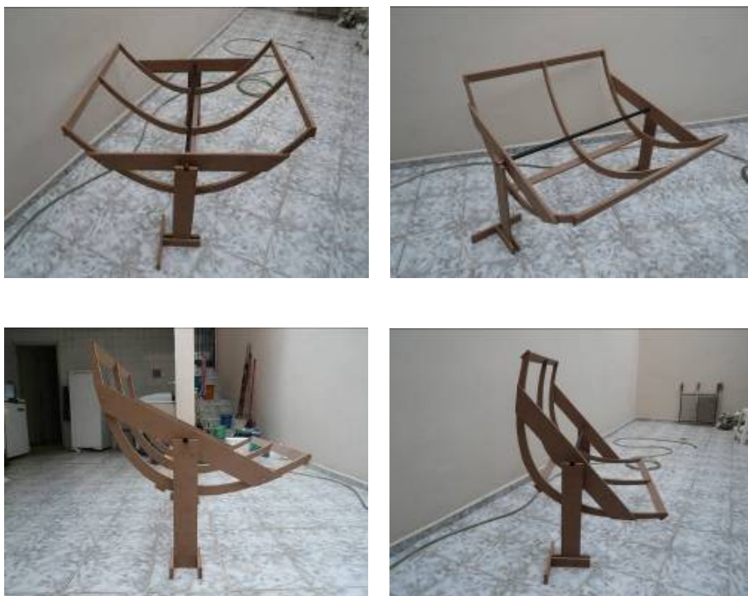
Fig.14. 8 – Estrutura da calha parabólica sobre os suportes e com o tubo ajustado.
