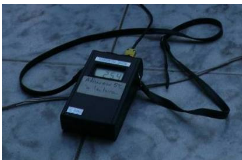
Fig.14. 23 – Termopar para medição da temperatura do reservatório.
