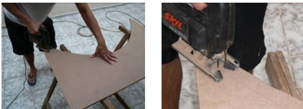
Fig.14. 6 – Detalhe de corte do MDF em formato parabólico.
