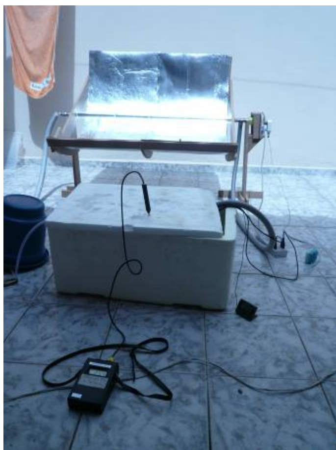
Fig. 16.1 – Protótipo de concentrador parabólico de foco linear em experimento.
