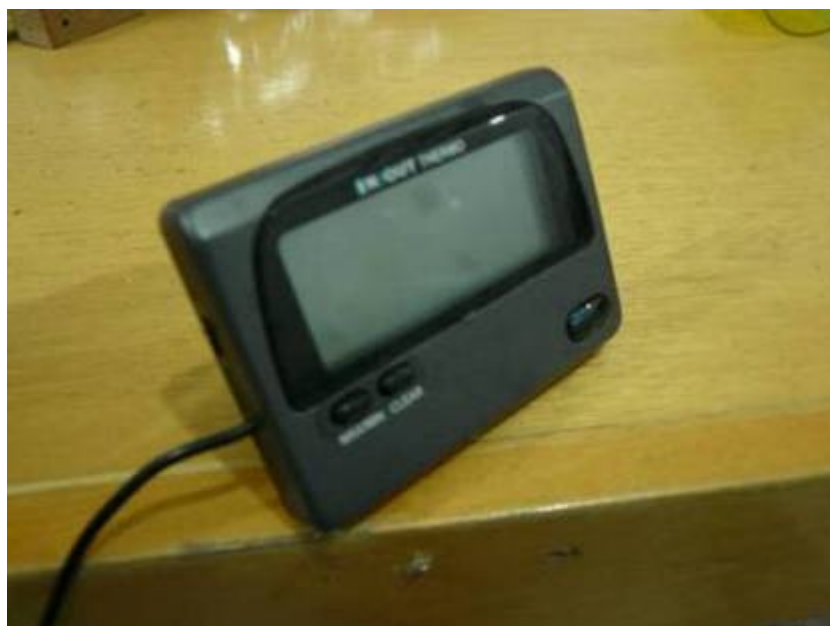
Fig.14. 22 – Termômetro digital para medição da saída de água.
