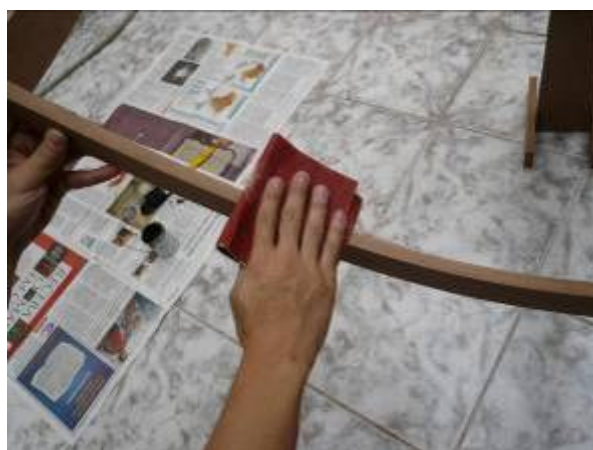
Fig.14. 7 – Acabamento das partes construídas em MDF utilizando uma lixa.
